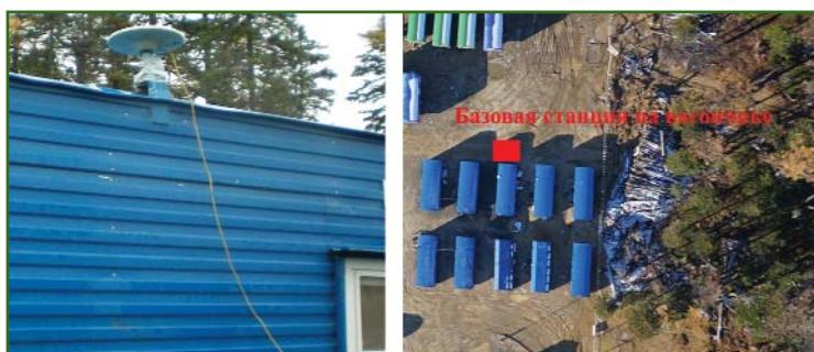
Рис. 3 Антенна базовой станции на земле (слева) и на снимке при высоте аэросъемки 150 м (справа)
