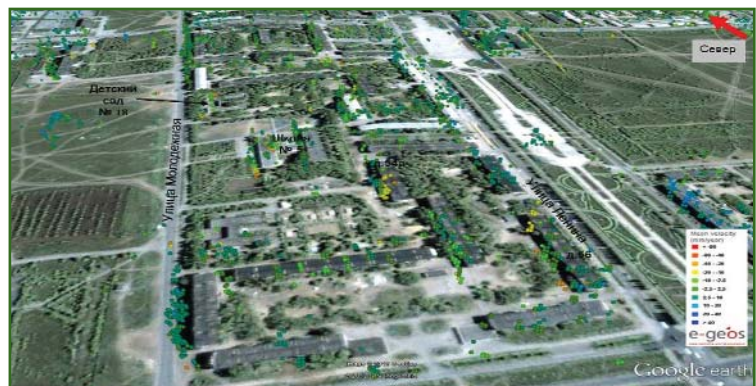
Рис. 7 Трехмерное изображение города Гаи и положение постоянных рассеивателей, выявленных между улицами Ленина и Молодежной
